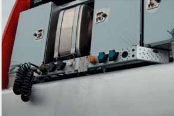
1.450 Liter Kraftstofftank, darüber 3 Edelstahlkisten, 120 Liter Alu-Hydrauliktank, hochgesetzte Anschlüsse für Elektrik, Luftversorgung und Hydraulik
