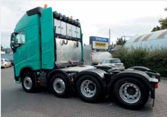
FH 540 Schmaler SL-Turm mit 600 bis 1.000 Liter Tank
