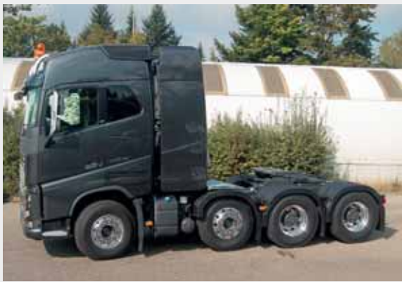
FH16-750 Euro 6 mit verstärktem Hilfsrahmen für Gesamtzuggewicht bis 180 to, Radstand 3.600 mm, Verschiebeeinrichtung
