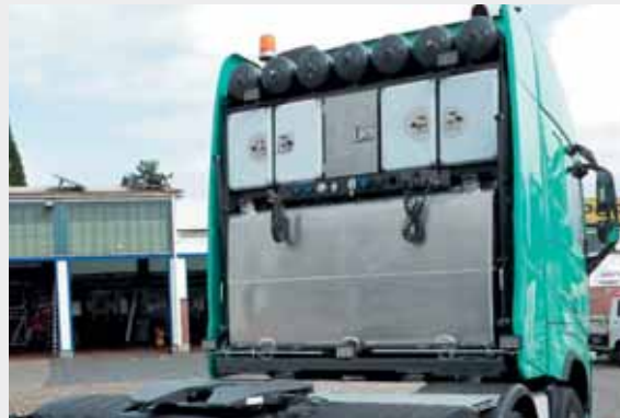
schmales Tankgestell für erhöhten Durchschwenkradius mit 1.000 Liter Tank, 4 Staukisten und mittige Kiste für Batterien
