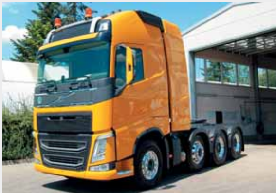
FH16-750 der kürzestmögliche Radstand ist 3.450 mm mit A-Maß 4.865 mm
